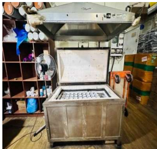
Сурет 14. Шелкография арқылы кружкаларға басылған бояуды пеште кептіру процесі (SAMAD Group, 2025).
