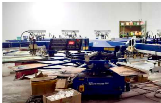
Сурет 7. Шелкография бойынша 12 баспалы автоматтық карусельді станок (ZIG.EMB.KZ, 2025)
