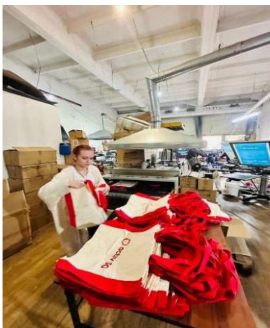
Сурет 12. Шелкография техникасымен басу соңында туннельді кептіру құрылғысы арқылы толық кептіріледі, кептірілгеннен кейінгі қол сөмкелерін жинақтау барысы (SAMAD Group, 2025).
