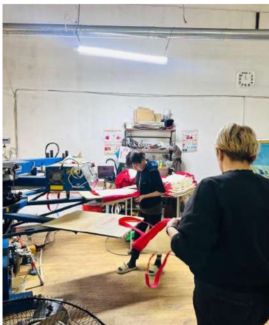
Сурет 10. Автоматты карусельді станок арқылы қол сөмкелеріне шелкография техникасы бойынша логотип басу процесі (SAMAD Group, 2025).
