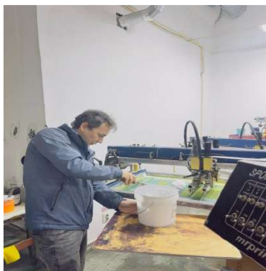
Сурет 18. Шелкография технологиясы бойынша бояу жағу барысы (ZIG.EMB.KZ, 2025).
