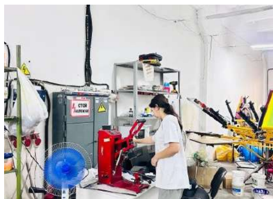
Сурет 8. Термопресс арқылы бас киімдерге логотип басу процесі (ZIG.EMB.KZ, 2025)
