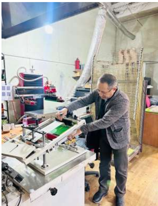
Сурет 9. Бояу құтыларының сыртына шелкография техникасы арқылы сурет басып шығаратын станокті көрсету процесі (SAMAD Group, 2025).
